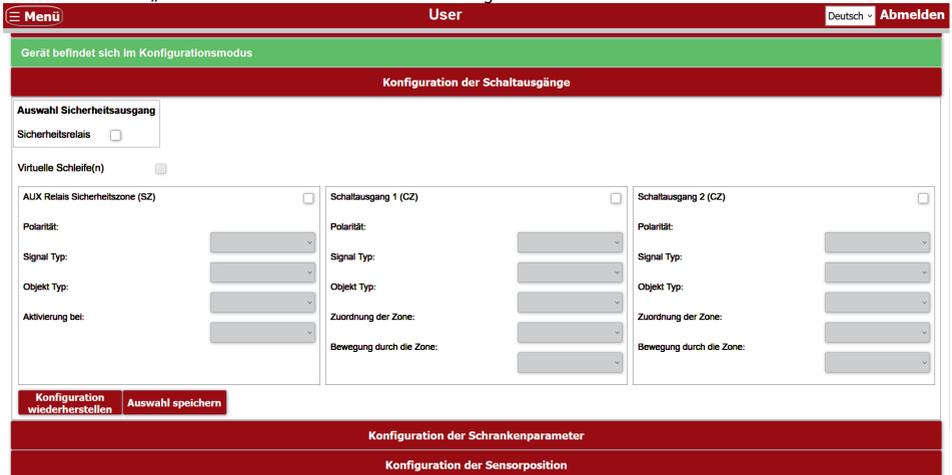
Die Auswahl „Sicherheitsausgang“ definiert je nach Hardware-Variante den Schaltausgangstypen. Es muss mindestens ein Sicherheitsschaltausgang aktiviert sein (Checkbox angewählt bzw. Auswahl Drop-Down Menü), damit der Sensor konfiguriert werden kann. Der Sicherheitsausgang schaltet, sobald ein Objekt die Sicherheitszone (SZ) aktiviert.
