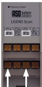
Anschlusskontakte für einen Sicherheitsausgang 8K2
