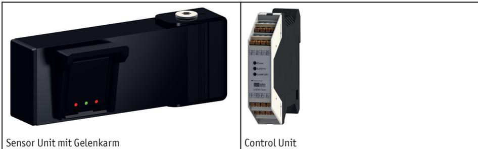
Das Sicherheitsradar besteht aus der Control Unit und zukünftig bis zu 6 Sensor Units. Mit dem Web-Interface wird das System und die Funktion konfiguriert und geprüft. Die Kommunikation zwischen den Sensor Unit und der Control Unit erfolgt über eine Busverbindung. An der letzten Sensor Unit wird ein Abschlusswiderstand angeschlossen.
