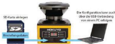
Auf PC erstellte Konfigurationen können auf einer SD-Karte gespeichert und anschließend zur Programmierung eines UAM verwendet werden. SD-Karten Konfigurationen sind durch Kennwort und Seriennummer geschützt.
